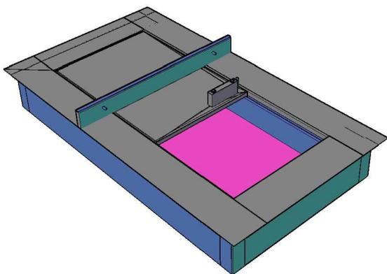
1. Лоток нижний – подвижный, противокрышке – шторке, отделка – нержавеющая сталь (зеркальная / шлифованная) или порошковое покрытие.
